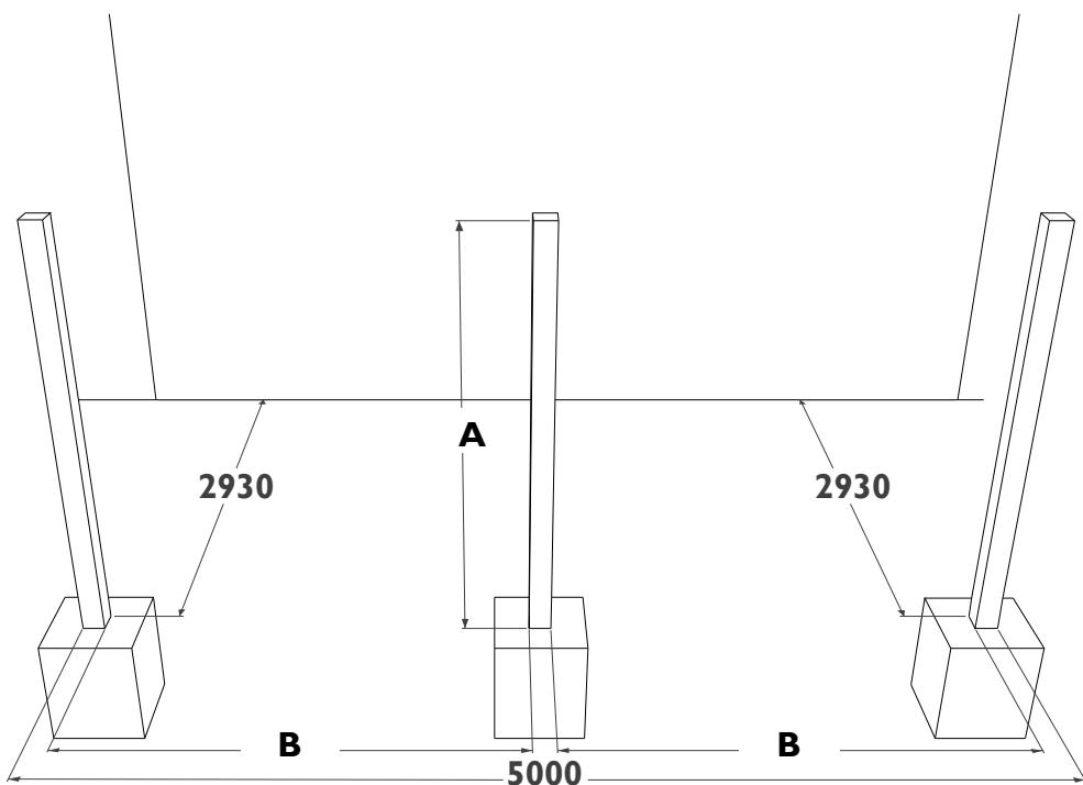
**NL:** Gebruik hulpstukken om de palen op hun plaats te houden bij het storten van het beton. Controleer na het storten of alle palen nog steeds correct opgesteld zijn en pas aan indien nodig. Geef uw beton de tijd om te drogen vooraleer U verder werkt.
