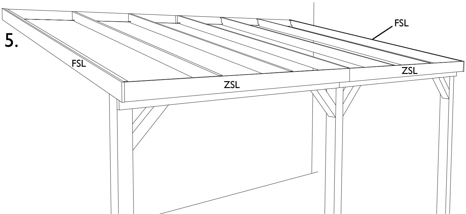
**NL:** Schroef de zijsierlatten (ZSL) kops tegen de dwarsliggers en de frontale sierlatten (FSL) vlak tegen de buitenste dwarsliggers.
