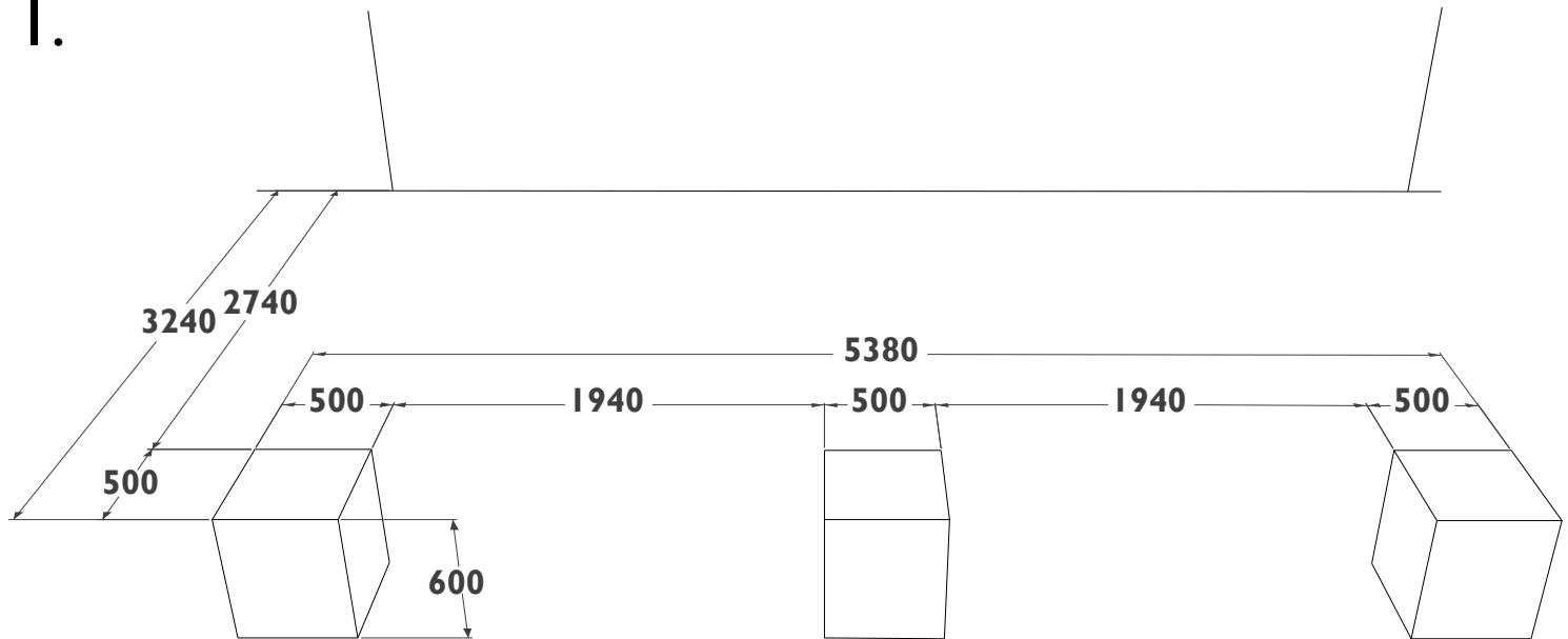
**NL:** Volg de maatindicaties op het bijgevoegd plan om uw palenpunten in of op de grond te betonneren. Zorg ervoor dat alle palenpunten onderling mooi uitgelijnd en verticaal staan. Gebruik goede beton, met keien. Laat U adviseren door een deskundige ter zake. Wapen uw beton. Maak putten van 50x50x60 cm (breedte/lengte/diepte).
