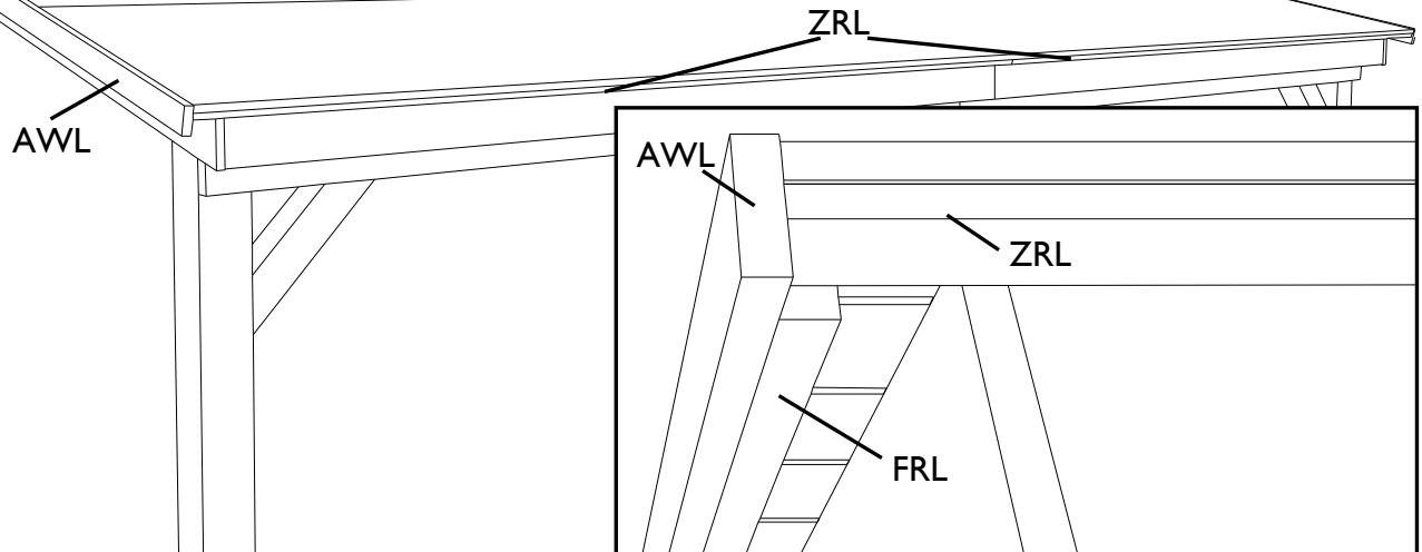
**NL:** Plooï de roofing om en klem onderaan vast met de roofinglijsten tegen de dakplanken. Plaats eerst de zijdelingse roofinglijsten (ZRL); gebruik hiervoor de vijsjes van 25 mm. Plaats dan de frontale roofinglijsten (FRL). Gebruik hiervoor vijsjes van 40 mm. Zorg ervoor dat de roofing tussen sierlat en dakplanken geklemd wordt. Tot slot brengt U afwerkingslat (AWL) frontaal aan. Vijs aan de frontale roofinglijsten met schroeven van 40 mm.
