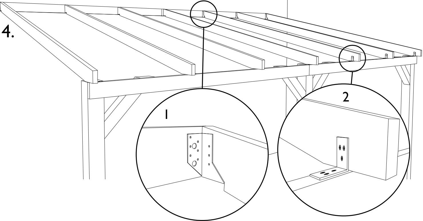
**NL:** Maak gebruik van de meegeleverde L-vormige balkverbinders (detail 1) om aan de muurbalk vast te maken. Gebruik de metalen winkelhaken om de dwarsliggers vast te zetten op de langsliggers (detail 2); gebruik telkens schroeven 35 mm. Verdeel de dwarsliggers evenredig over de volledige lengte, plaats de uiterste dwarsliggers helemaal op de buitenzijde van de langsligger. Plaats de middelste dwarsbalk precies in het midden. Verdeel de 4 ander dwarsliggers symmetrisch.
