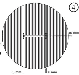
Posez les éléments de terrasse avec un écartement minimum de 30mm des murs ou d' autres obstacles pour permettre la dilatation du bois. Maintenez une distance d' au moins 10mm entre les têtes et de 8mm entre les longueurs des lames ( figure 4 ). Si vous utilisez des lames de terrasse d' une longueur de 400cm ou 500cm, la distance entre les têtes doit être au moins de 15mm.
