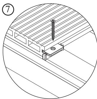
Wenn zwei Terrassendielen miteinander durch den Montageclip verbunden sind, verschrauben Sie den Clip fest mit der Unterkonstruktion ( Abb.7 ).
