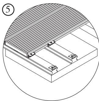
Die beiden äußeren Terrassendielen befestigen Sie mit den Bear County Start- / Endclips. Wichtig: Bei der Befestigung der Montageclips ist ein Vorbohren mit einem 2,5mm Bohrer erforderlich um ein Reißen oder Brechen der Unterlagsriegel zu vermeiden.
