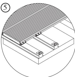
De twee buitenste terrasdelen legt u met de Bear County start / eindclip. Belangrijk: Bij bevestiging van de montageclips, start / eindclips is voorboren met een 2,5 mm boor noodzakelijk om scheuren of breken van de onderconstructie te voorkomen.
