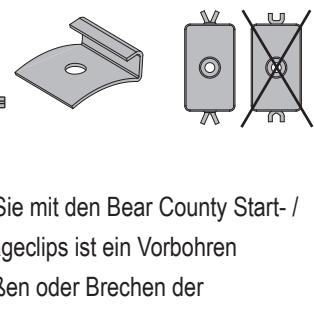
Sie platzieren die erste Terrassendiele in den Start- / Endclips ( Abb.5 ). Bei Befestigung dafür sorgen das die " Flügel" der Clips nicht zusammengedrückt werden. Danach befestigen Sie jede nachfolgende Terrassendiele mit Hilfe der Montageclips ( Abb.6 ). Die Schrauben nur handfest anziehen.
