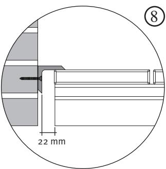
Für ein schönes Resultat verwenden Sie die Winkel- oder Abdeckleiste um die Seiten der Terrasse abzuschließen. Sorgen Sie für einen Abstand von 22mm zwischen Mauer und Terrassendiele damit das Material ,arbeiten' kann ( Abb.8 ). Die Ecken schließen Sie sauber mit den Winkelprofilen ab.
