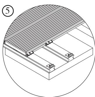
Posez les cavaliers d' extrémité extérieurs de terrasse avec les pattes de vissage. Important: Lors de la fixation des clips de montage, il faut forer au préalable avec une mèche de 2,5mm pour éviter les fissures des lambourdes. Placez la première lame dans les cavaliers d' extrémités ( figure 5 ), vous fixez ensuite chaque module de terrasse suivant à l' aide des clips de montage ( figure 6 ). Les vis doivent être serrées à la main.
