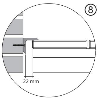
Pour une jolie finition, vous pouvez utiliser nos cornières d'angle ou Clip de fermeture des lames (pas inclus). Fixez les cornières contre le mur et non sur les éléments de terrasse, cela permettra à l'ensemble de se dilater. Il faut toujours veiller qu'il y ait un espace de 22mm entre la finition et la lame (figure 8).
