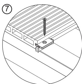
Als twee terrasdelen aan elkaar zijn bevestigd door middel van de montageclip, schroeft u de clip vast in de onderregel ( fig.7 ).
