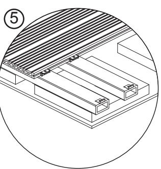
Posez les cavaliers d'extrémité extérieurs de terrasse avec les pattes de vissage. Important: Lors de la fixation des clips de montage, il faut forer au préalable avec une mèche de 2,5mm pour éviter les fissures des lambourdes. Placez la première lame dans les cavaliers d'extrémités (figure 5), vous fixez ensuite chaque module de terrasse suivant à l'aide des clips de montage (figure 6). Les vis doivent être serrées à la main.
