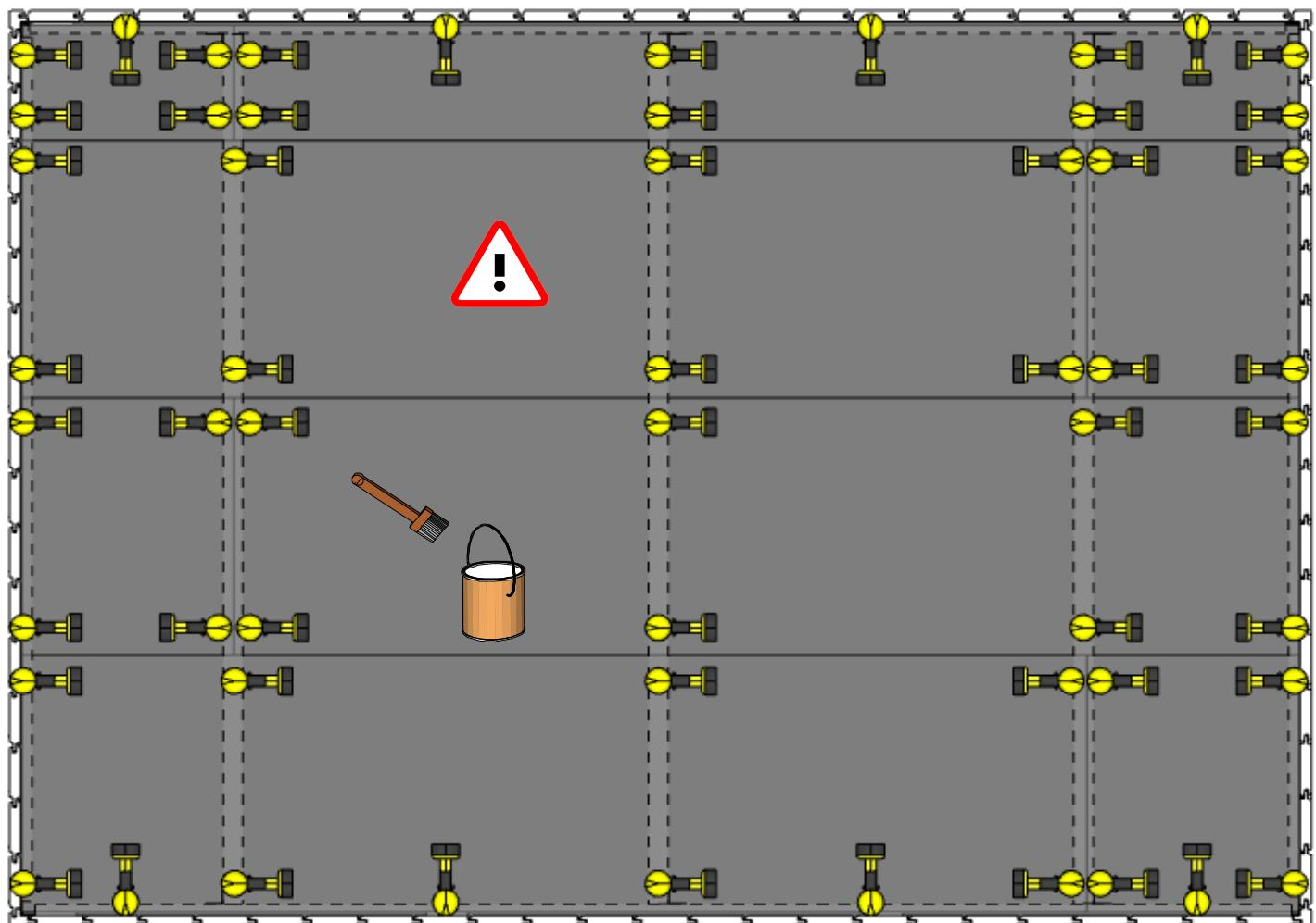
Behandel de OSB3 dakplaten aan boven en onderkant met een beschermlaagbeits of andere verf, dit zorgt voor een
