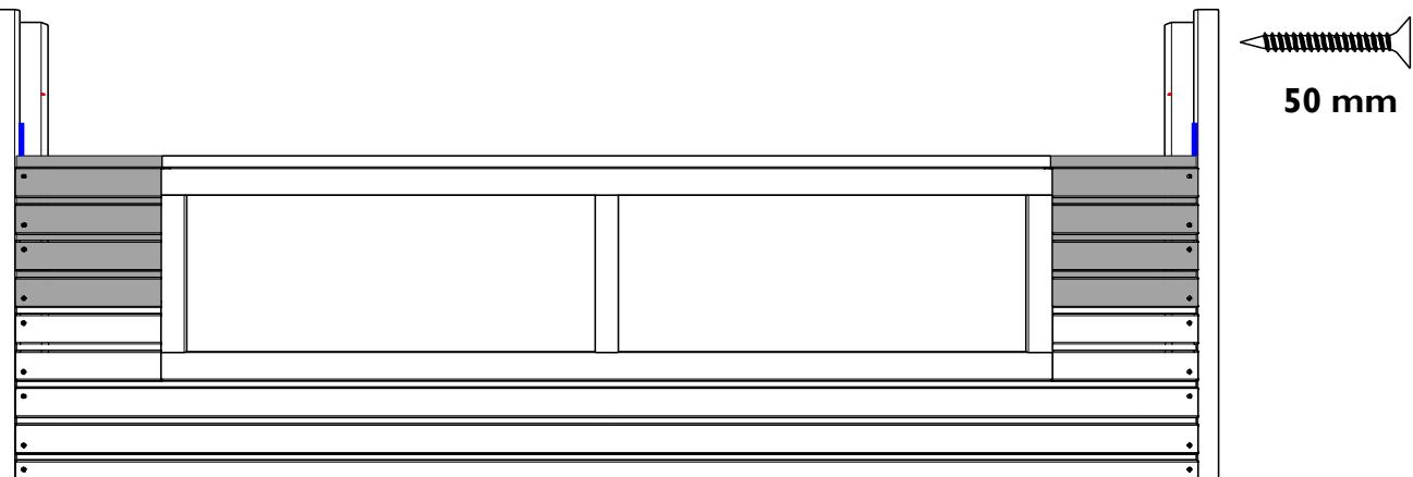
**NL:** Bevestig aan de binnenkant het raam door de groef aan de tand van de bovenste kleine stukken. Vergeet zeker niet voor te boren!
