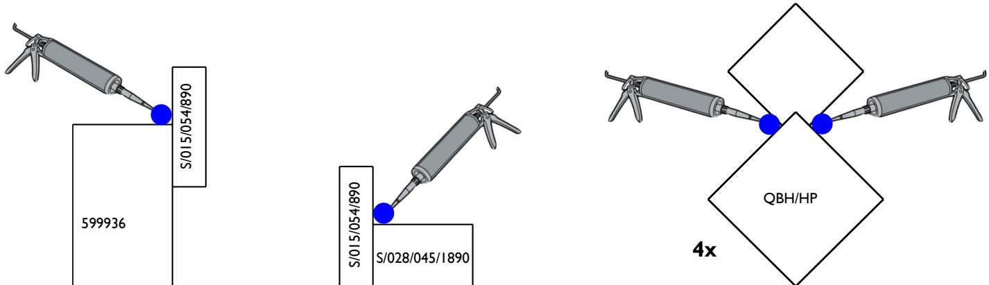
**NL:** Raadpleeg de plannetjes en de referenties in de onderdelenlijst om te weten welke planken u nodig heeft om de basislaag te vormen. Breng aan de uiteinden van elke plank een streep lijm aan en vijs de plank door de voorgeboorde openingen op het hoekprofiel / deurkader. Zorg dat alles haaks staat. **Opgelet!** Bij de hoekprofielen zit het "kleinere" balkje aan de buitenzijde van de constructie.
