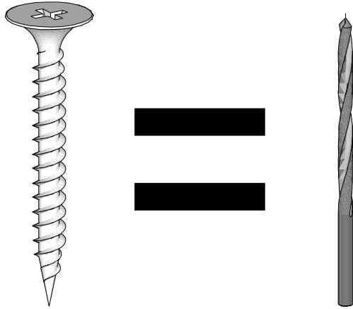
**NL:** Vijzen = Voorboren! Om te vermijden dat hout splijt tijdens het vijzen dient u telkens voor te boren met een boor met een diameter gelijk aan de diameter van de kern van de vijs.
