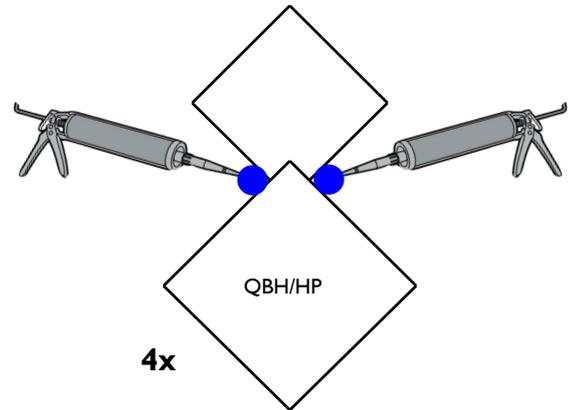
**NL:** Raadpleeg de plannetjes en de referenties in de onderdelenlijst om te weten welke planken u nodig heeft om de basislaag te vormen. Breng aan de uiteindes van elke plank een streep lijm aan en vijs de plank door de voorgeboorde openingen op het hoekprofiel / deurkader. Zorg dat alles haaks staat. **Opgelet!** Bij de hoekprofielen zit het "kleinere" balkje aan de buitenzijde van de constructie.
