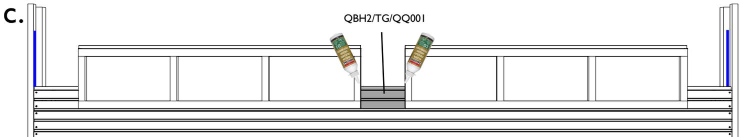
**NL:** Bevestig aan de binnenkant het raam door de groef aan de tand van de kleine stukken. Zorg er voor dat de onderzijde van het raam mooi overloopt in de lijn van de kleine stukken. Vergeet hier zeker niet voor te boren!
