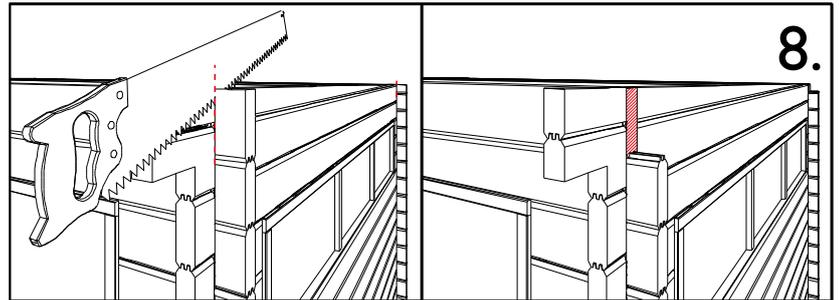
**NL:** Maak een T-profiel. Vijs de sierlat FSL/2100 met 5 vijzen van 35 mm op het balkje S/045/045. **Opgelet!** Let op de positie van het balkje: aan 1 kant gelijk en aan de ander steekt de sierlat uit. Bevestig op de zelfde manier de sierlat 599906 om zo een H-profiel te maken. **Let op** de positie van de 2 kleine gaatjes!
