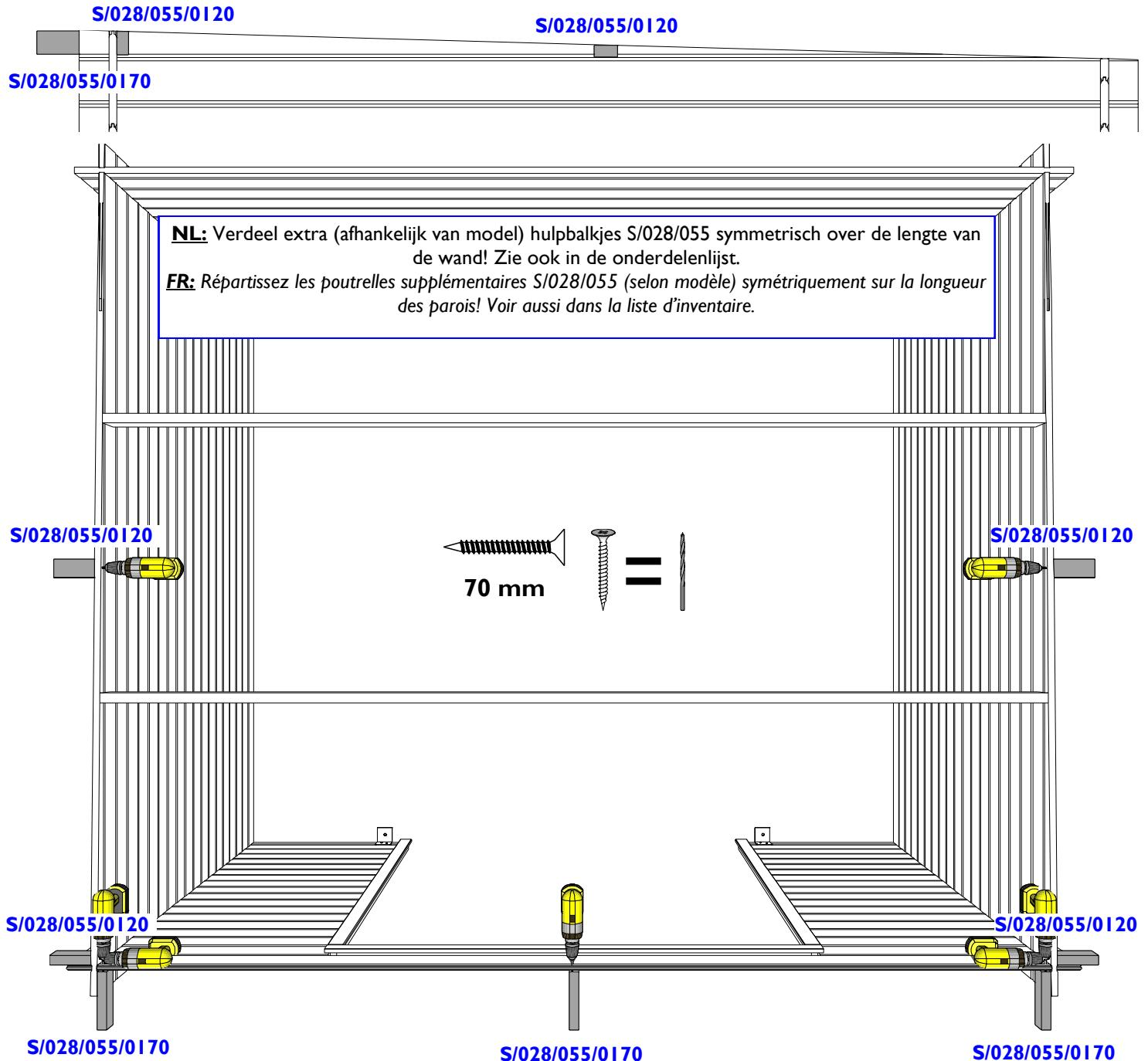
**I 3.** **NL:** Monteer de sierlatten FSL tegen de hulpdakbalkjes, 4cm boven de hulpdakbalkjes S/028/055 aan de voorkant. De planken FSL kunnen in meerdere delen zijn of in aantallen verschillen volgens het model, zaag indien nodig op lengte. Zie ook in de onderdelenlijst.
