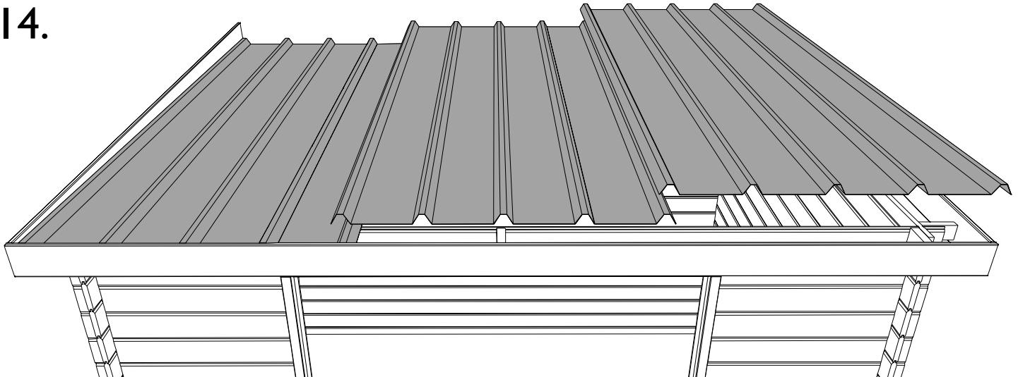
**NL:** Plaats de dakplaten PPD1AC, maak nog **niet** vast! Duid de positie van de dakbalken en wanden aan met een potlood. Begin steeds met de op breedte gezaagde plaat (volgens model). Indien u een model kocht met staalplaten met anti-condensdoek, zorg er dan voor dat de buitenste golf zonder anti-condens doek de vorige plaat overlapt. **Het aantal dakplaten kan verschillen volgens uw aangekocht model !**
