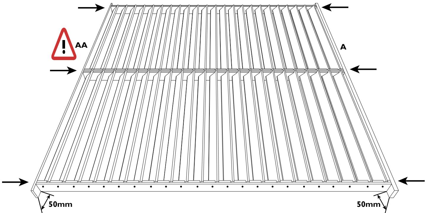
**NL:** Bevestig, links van een samengesteld dakpaneel, een dwarsligger A en rechts een dwarsligger AA. De dwarsliggers steken aan beide zijdes 50mm uit. Schroef vast met 6 schroeven van 50mm per dwarsligger.
