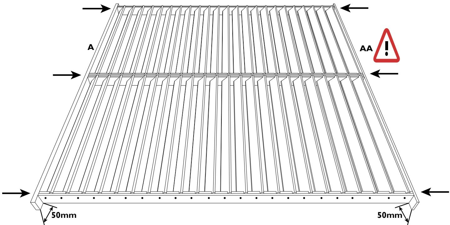
**10.** **NL:** Plaats, met minstens 3 volwassen personen, het eerste dakpaneel uit punt 9 op de palen. De langsliggers in de uitsparing van de balken. De Dwarsligger A aan de buitenzijde, de dwarsligger AA aan de binnenzijde. Hou rekening met de oriëntatie van de lamellen tot de zon. Bevestig met 2 schroeven van 70mm per paal, zowel de langsliggers als de dwarsligger A aan de palen.
