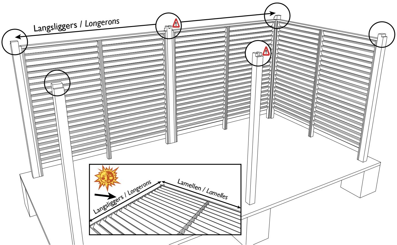
**NL:** Plaats de palen, met de lengterichting van de uitsparing bovenaan evenwijdig met de langsliggers (zie tekening), in de ijzers en maak vast. Hou, bij het plaatsen van de palen, rekening met de oriëntatie van de lamellen t.o.v. de zon. Controleer of de palen waterpas staan en alle afmetingen kloppen met het grondplan bij punt I.
