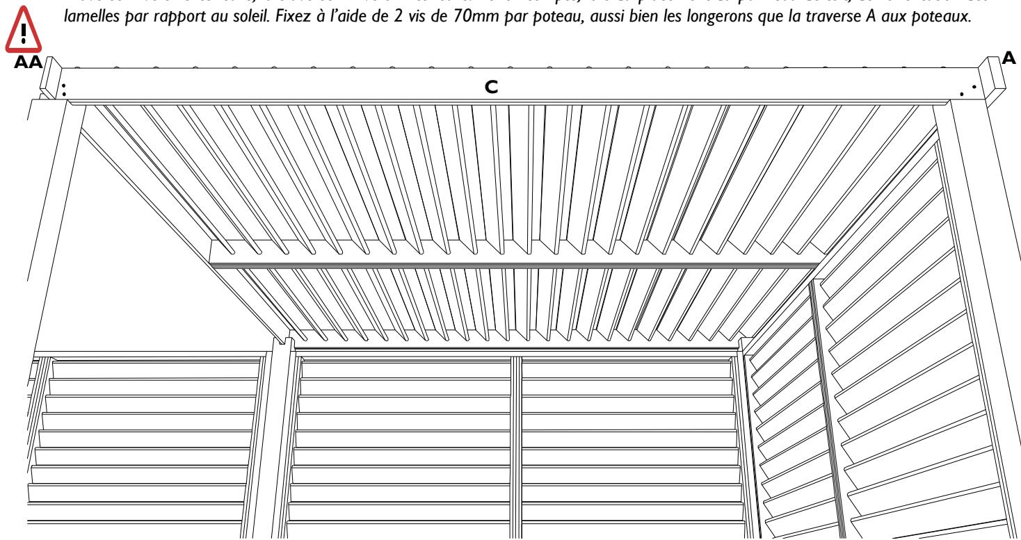
**NL:** Plaats, met minstens 3 volwassen personen, het tweede dakpaneel uit punt 9 op de palen. De langsliggers in de uitsparing van de balken. De Dwarsligger A aan de buitenzijde, de dwarsligger AA aan de binnenzijde. Hou rekening met de oriëntatie van de lamellen tot de zon. Bevestig met 2 schroeven van 70mm per paal, zowel de langsliggers als de dwarsligger A aan de palen. Bevestig tot slot de 2 dwarsliggers AA aan elkaar met 10 schroeven van 25mm
