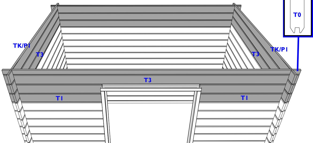
**NL:** Indien er hoogteverschillen zijn tussen de wanden onderling, controleert u of planken goed aansluiten. Om een hoogteverschil op te vangen (detail A) brengt u de bovenste plank gelijk met de puntgevel en vijs deze aan elkaar (detail B). Breng nu dmv kleine tikjes de onderliggende planken 1 voor 1 omhoog (detail C) om zo de spatie te verdelen over alle planken (detail D).
