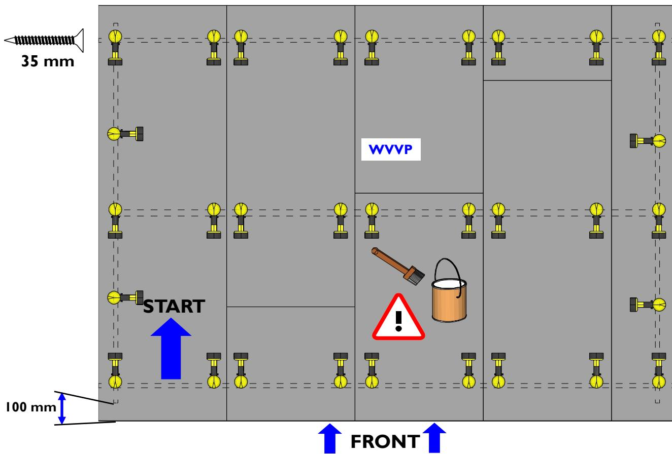
Behandel de dakplaten aan boven en onderkant met een beschermlaagbeits of andere verf, dit zorgt voor een aanzienlijke langere levensduur van uw product en helpt schimmel voorkomen.
