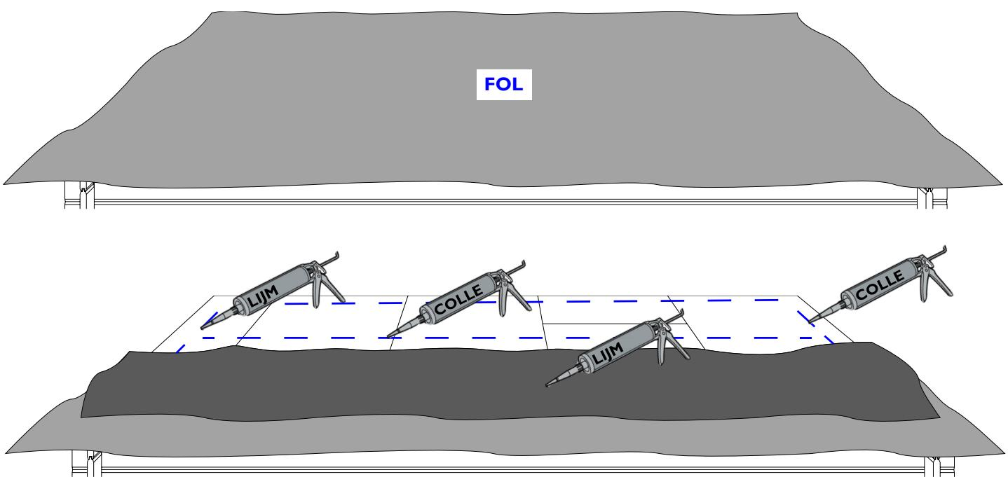
**9.** **NL:** Plaats nu de sierlatten FSL aan de voorkant en zijkanten. Plooit de folie naar onder toe over de platen zodanig dat de folie tussen de sierlatten en de platen vast zit.
