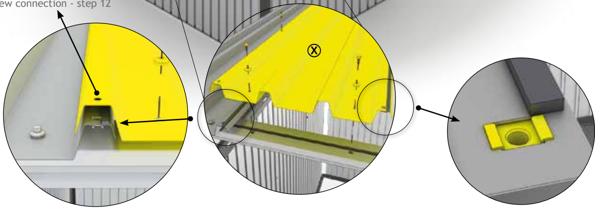
Verschraubung - Schritt 12 screw connection - step 12
