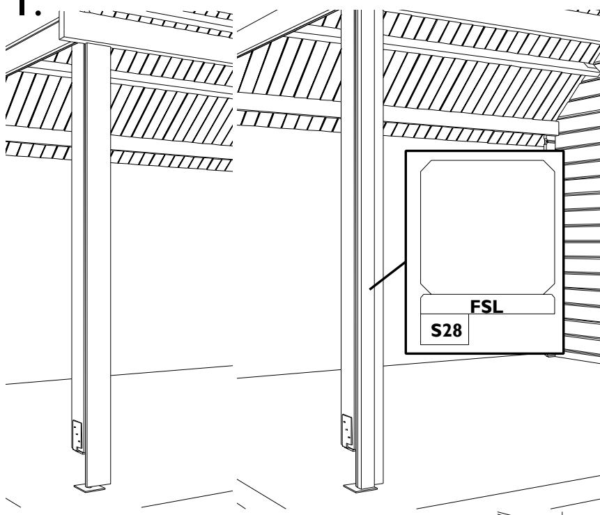
**NL:** Bevestig op de hoekpaal, met de bovenkant tegen de ligger, de lat FSL met 5 vijzen van 35 mm. Bevestig nu de lat S/028 met 5 vijzen van 50 mm aan de buitenrand van de lat FSL (zie detail).
