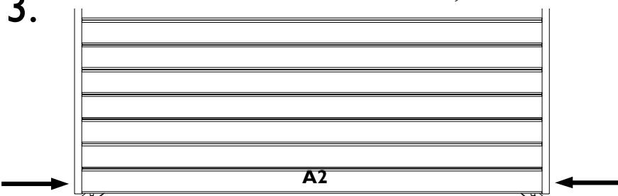
**NL:** Bevestig de onderste plank A2, door 2x2 vijzen van 70 mm door de latten S/028 te vijzen.
