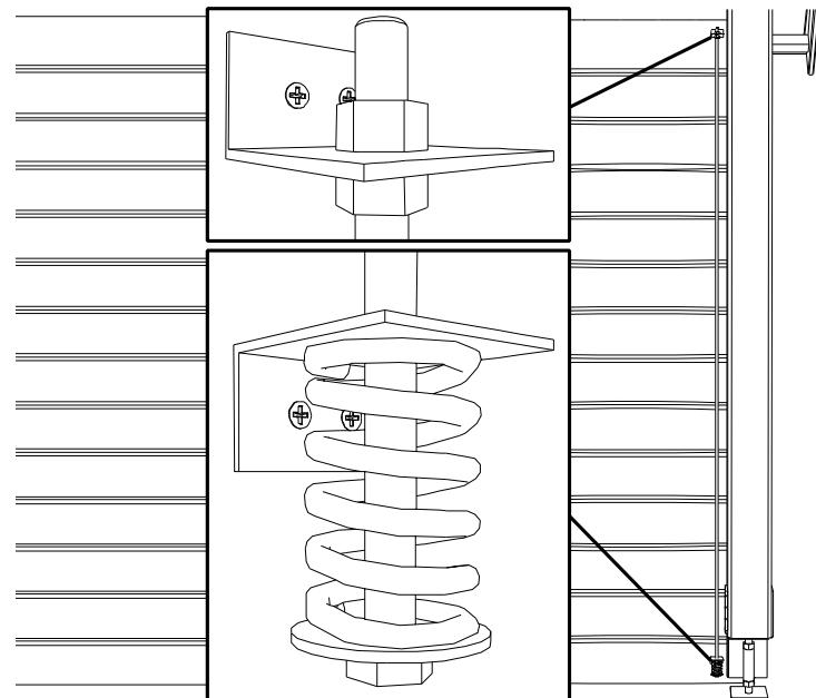
**NL:** Bevestig naast de paal op de onderste en bovenste plank een L-ijzer met draadstang en veer. Deze draadstang zal er voor zorgen dat de planken aan de kant van de paal altijd netjes in elkaar blijven zitten (zie ook “hout leeft”). Bij extreme droogte zou het toch kunnen dat er spleten tussen de planken ontstaan, draai dan de veer iets aan. **Opgelet!** Bevestig geen draadstang aan de kant van de blokhut, deze zou de natuurlijke werking van de blokhut kunnen belemmeren.
