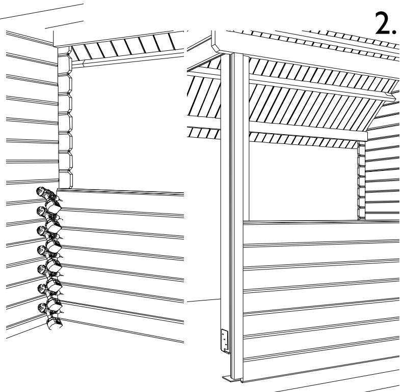
**NL:** Plaats nu de eerste 7 planken A2 tussen de blokhut en de paal zoals op de tekening. Vijs elke plank tegen de blokhut met 2 vijzen van 50 mm. **Opgelet!** Aan de kant van de paal wordt er niet gevezen.
