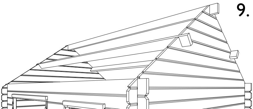
**NL:** Werk de puntgevels verder af. Herhaal hiervoor stappen 7 en 8 tot U aan de nokbalk komt, plaats ook deze. (Het aantal dakbalken van uw blokhut kan afwijken t.o.v. de tekening).
