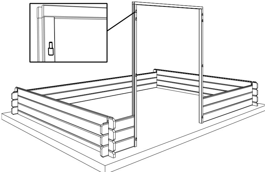
**NL:** Bouw verder op volgens de meegeleverde plannetjes (zie gedetailleerde onderdelenlijst) tot U ter hoogte van de onderkant van de ramen komt. Plaats nu nog 2 lagen extra. Laat het raamkozijn in de opening zakken met gaten van de indraaischarnieren langs de buiten- en bovenkant. Het afwerken van opgaande ramen (afhankelijk van het model) doet U best als de blokhut volledig gemonteerd staat. **Maak uw kader niet vast dmrv bv schroeven of nagels aan uw berghing! ("Hout leeft").**
