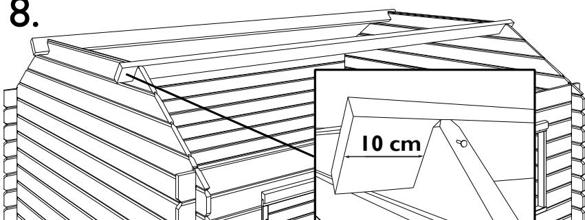
**NL:** Plaats de dakbalken P in de uitsparingen van de puntgevels. De dakbalk stekt 10 cm langs voor en achter uit de puntgevel (zie detail). Nagel elke balk aan de puntgevel vast.
