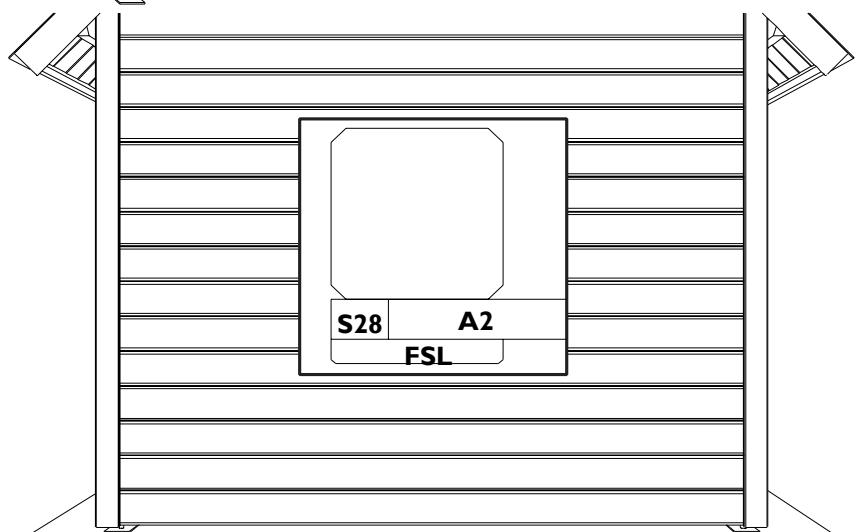
**NL:** Ten slotte dient u enkel nog de sierlijst FSL te bevestigen met 5 vijzen van 50 mm.
