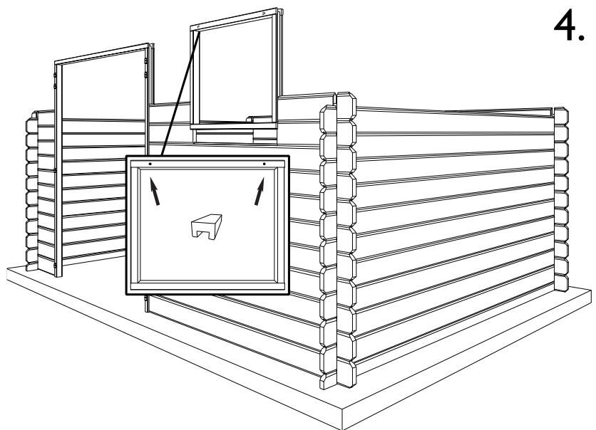
**NL:** Bouw verder tot u aan de bovenkant van de deurkader(s) uitkomt. Boven de deurkader(s) dient u de plank C8 te plaatsen. Zaag eerst uit tot op de sleuf. **Opgelet!** Zaag uit van de groef (onderkant plank) naar de sleuf!!
