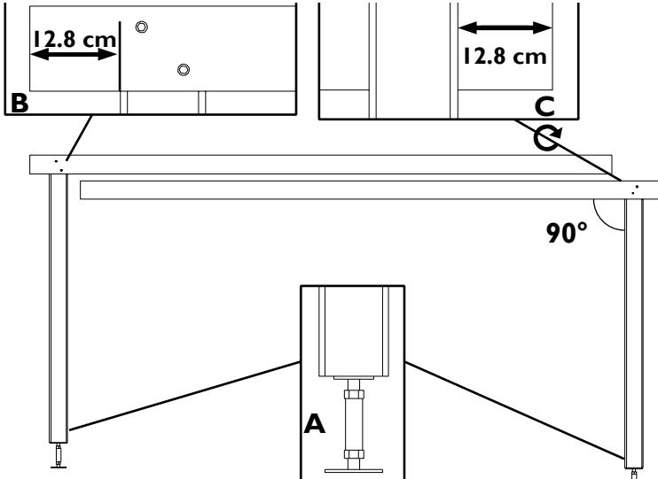
**NL:** Monteer, op grondniveau, op elke paal S onderaan een regelbare voet 300035 met 4 draadbouten met carrosseriering (detail A) en bovenaan met 2 draadbouten met carrosseriering een ligger P4/3800, laat de langsligger met de schuine kant 12,8 cm uitsteken (detail B en C). Monteer één ligger links en de andere rechts zoals op de tekening.
