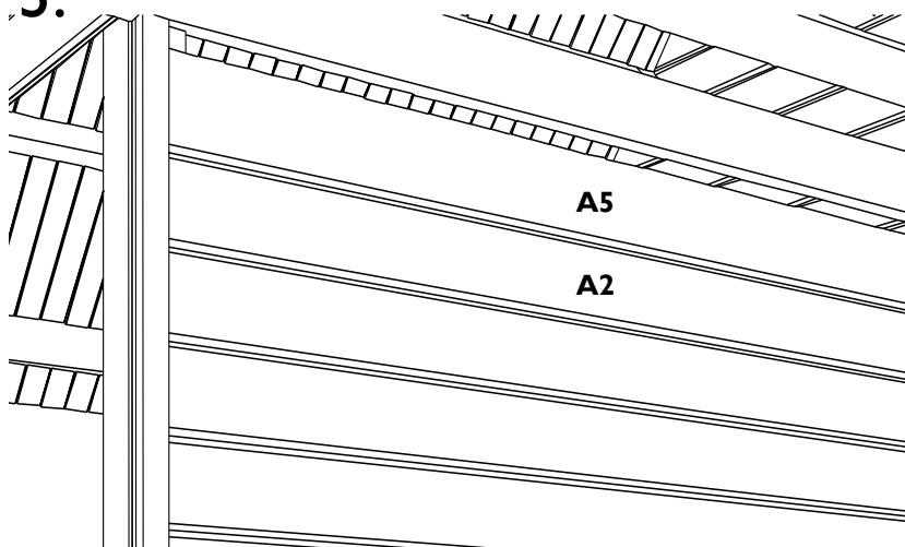
**NL:** Plaats nu de overige planken tussen de blokhut en de paal. De bovenste plank A5 heeft geen tand, enkel een groef, zij is m.a.w. vlak bovenaan. Vijs elke plank tegen de blokhut met 2 vijzen van 50 mm. **Opgelet!** Aan de kant van de paal wordt er niet gevezen.
