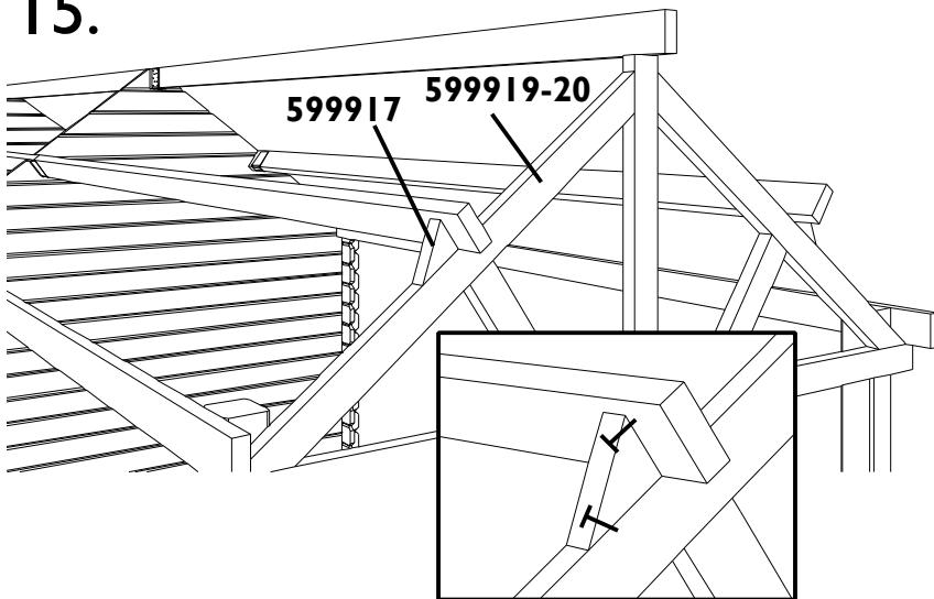
**NL:** Plaats de dakbalken P4/3700 van de extensie in de metalen balkverlengers. De nokbalk komt in het midden van de middenste hangstijl en wordt bevestigd d.m.v. 2 L-ijzers 20x20 links en rechts van de balk. De andere balken komen evenwijdig met de nokbalk op de spantbenen (599917) te liggen. Monteer naast de dakbalken de balk steunen (599919 of 599920) d.m.v. vijfzen van 100 mm.
